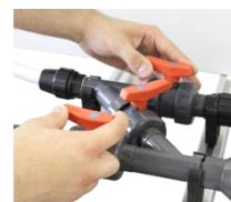
•• Comienza a circular el agua. Con la válvula que tenemos en la parte superior del depósito de salida inferior, regulamos la relación agua/aire que queremos en dicho depósito. ¶
