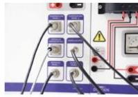
••• Para poder controlar el encendido y apagado de los focos, los conectamos al equipo por la parte trasera del módulo MP-EF10-Control-fotovoltaica-con-PC. 6
